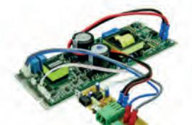
Amplificatore classe D 500W, uscita 100 V, alim. 24 Vdc.
