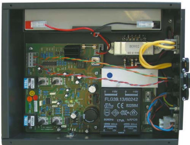
Der ILD15 als Version ILD15BB mit Notstromversorgung
